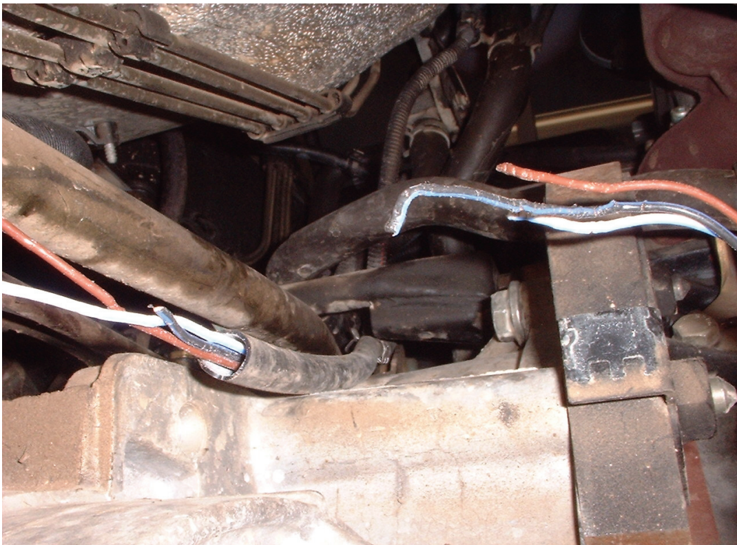
Door steenmarter doorgebeten elektrische bedrading in motorruimte (foto: G. Miskens).
